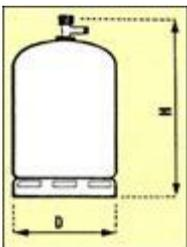
***UTILISER DES RECIPIENTS GAZ DE 13 KG (BUTANE OU PROPANE) D'UNE HAUTEUR MAXIMALE DE 615 MM SUR UN DIAMETRE EXTERIEUR DE 310 MM***
