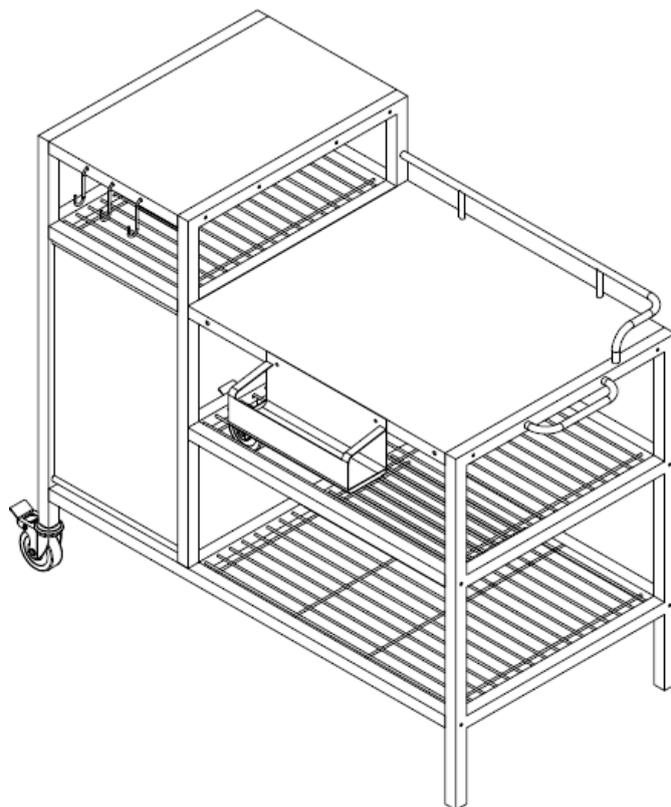
**Ne déplacez pas le chariot avec la plancha et la bouteille de gaz.**
