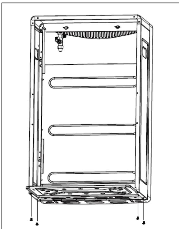
5. Faites correspondre le panneau latéral avec le support de bouteille de gaz dans quatre trous, utilisez le tournevis pour fixer avec 4 vis M5\*8.
