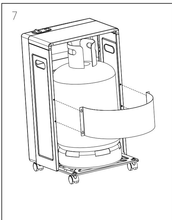
7. Placer la bouteille de gaz dans le chauffage et fixer le cache bouteille pour la maintenir.
