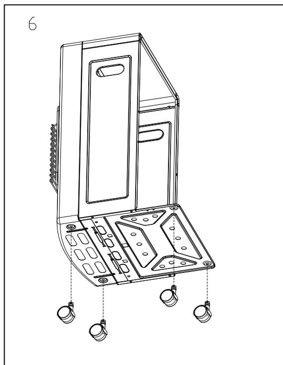
6. Fixez les quatre roues au support de la bouteille de gaz et au panneau avant en utilisant la clé pour bloquer les 4 écrous M8 afin de rendre le chauffage de manière stable.
