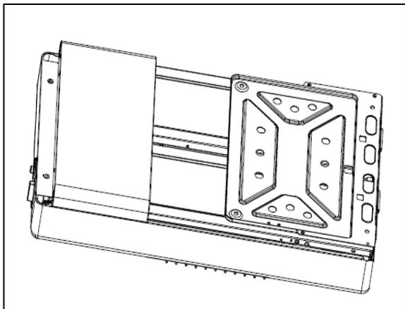
1. Sortir le chauffage de son emballage et placer le sur le caton d'emballage ou une autre protection pour ne pas l'abîmer
