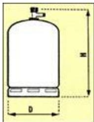
UTILISER DES BOUTEILLES GAZ DE 13 KG (BUTANE OU PROPANE) D'UNE HAUTEUR MAXIMALE DE 615 MM SUR UN DIAMETRE EXTERIEUR DE 310 MM
